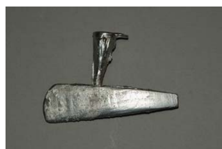
Das Endergebnis: Beilklinge von rund 11 cm Länge mit noch nicht entferntem Gussstrichter an der Oberseite.
