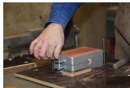
Schritt 3: Der obere und untere Teil der Gussform werden getrennt.
