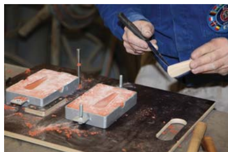
Schritt 4: Das Beilklingenmodell wird vorsichtig entfernt und die beiden Gussformhälften wieder zusammengesetzt.
