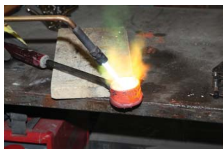
Schritt 5: Das Zinn wird im Schmelztiegel erhitzt, bis es flüssig ist.
