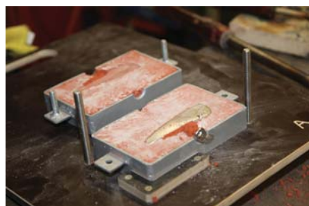
Schritt 7: Nach dem Erkalten des Zinns wird die Gussform geöffnet und die Beilklinge herausgenommen.
