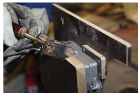
Schritt 6: Nun wird das flüssige Zinn vorsichtig in die Form gegossen.
