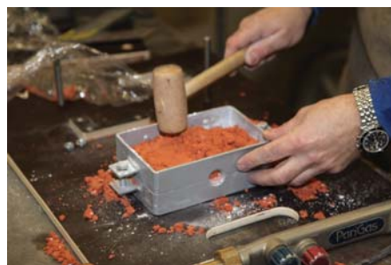
Schritt 2: Ein zweiter Metallrahmen wird auf den unteren Teil der Gussform gesetzt, mit Gussand gefüllt und mit dem Hammer gut verdichtet.
