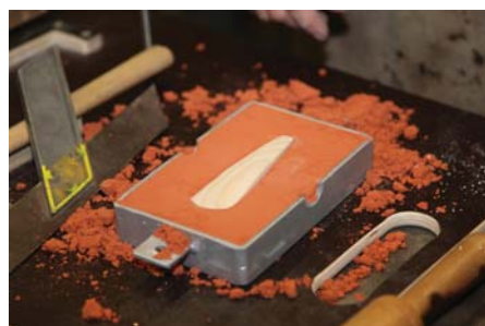
Schritt 1: Gussand oder Ton wird in einen Metallrahmen gefüllt, danach wird das Model der Beilklinge in die Gussform gepresst.
